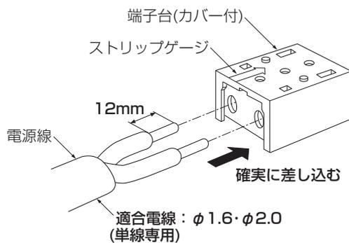
電源線を取外す場合は、カバーを取外してマイナスドライバー等をはずし穴に差し込み、電源線を引き抜く。
