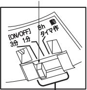
動作設定ツマミを動かすことで「8hタイマ」、「ON/OFF(1分)」、「ON/OFF(3分)」の3つのセンサーモードが設定できます。
