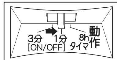
※出荷時の各ツマミ位置は、点灯照度設定ツマミ「切」、動作設定ツマミ「ON/OFF1分」となっています。
