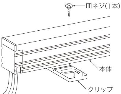
※壁面取付けの場合、横長付け・縦長付けのどちらでも取付可能です。
