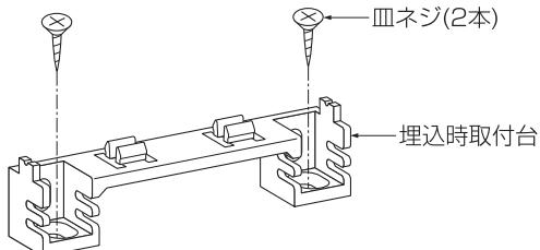
※壁面埋込みの場合、横長付け・縦長付けのどちらでも取付可能です。
