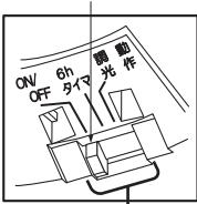
動作設定ツマミを動かすことで「調光」、「6h タイマー」、「ON/OFF」の3つのセンサー モードが設定できます。
