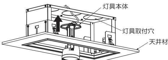
②灯具本体を下図のように回し、灯具固定ネジ(各2ヶ所)にはめ込み、ドライバーで灯具固定ネジ(2ヶ所)を確実に締め付け固定してください。
