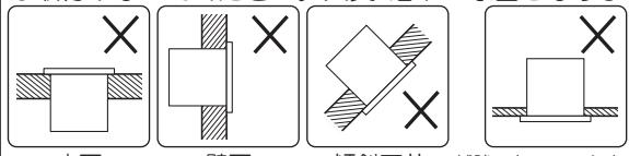
断熱材・防音材をかぶせた状態で使用しないでください。過熱して火災の原因となります。
