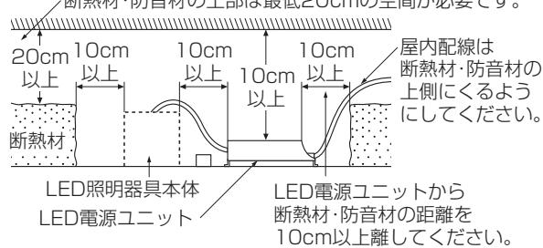
LED電源ユニット本体表示または本説明書に従って施工してください。施工に不備があると、火災・感電・落下の原因となります。
