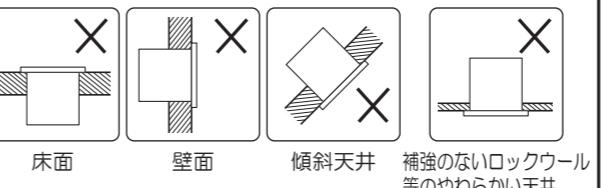
断熱材・防音材をかぶせた状態で使用しないでください。過熱して火災の原因となります。
