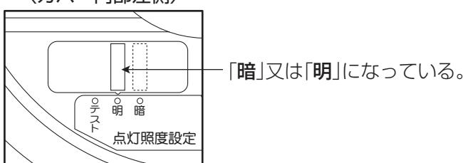
カバー内部センサー左側の点灯照度設定のツマミを「暗」又は「明」に合わせる。
