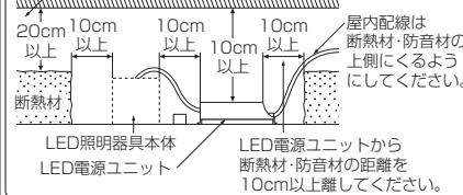
LED電源ユニット本体表示または本説明書に従って施工してください。施工に不備があると、火災・感電・落下的原因となります。
