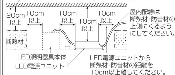
LED電源ユニット本体表示または本説明書に従って施工してください。施工に不備があると、火災・感電・落下の原因となります。
