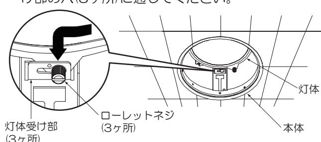
②灯体を止まるまで回転させ、ローレットネジを締め付けて灯体を固定してください。
