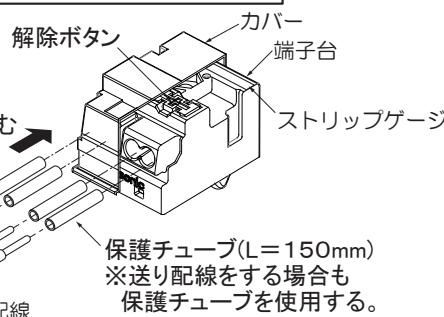
適合電線: VVF  $\phi$  1.6・ $\phi$  2.0
