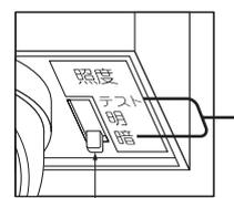
点灯照度設定ツマミを動かすことで、センサーが動作する明るさの設定と感知エリア確認(テストモード)ができます。
