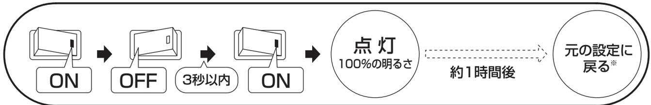
注) 上記壁スイッチ操作を行うと、周囲の明るさに関係なく約1時間連続点灯します。
