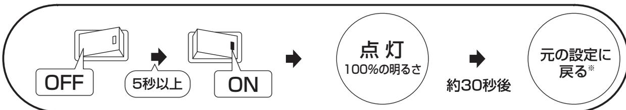
注) 上記壁スイッチ操作を行うと、周囲の明るさに関係なく壁スイッチを「ON」にした直後は約30秒間ランプが点灯し、その後、元の設定に戻ります。
