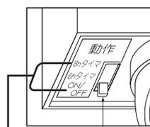
動作設定ツマミを動かすことで「8hタイマ」、「6hタイマ」、「ON/OFF」の3つのセンサーモードが設定できます。
