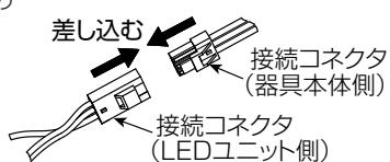
(3) LEDユニットのね受け金具近傍を持ち、電線を挟まないように器具本体側へ押し上げてLEDユニットを取付ける。
