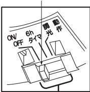
動作設定ツマミを動かすことで「調光」、「6h タイマー」、「ON/OFF」の3つのセンサー モードが設定できます。
