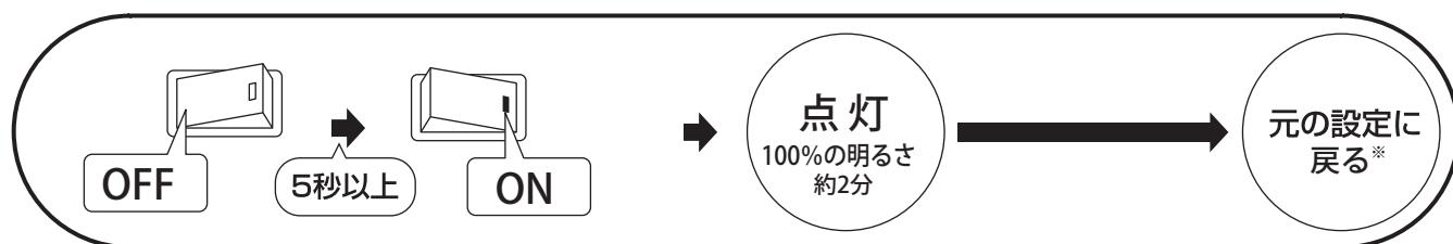
注) 上記壁スイッチ操作を行うと、周囲の明るさに関係なく壁スイッチを「ON」にした直後は約2分間LEDが点灯し、元の設定に戻ります。
