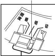
点灯照度設定ツマミを動かすことでセンサーが動作する明るさの設定ができます。
