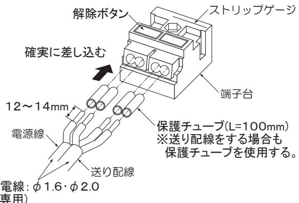
電源線を取外す場合は、マイナスドライバー等で解除ボタンを押しながら、電源線を引き抜く。
