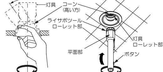
※角度調整しにくい場合は、灯具を一度引き抜いてから、首振及び回転角度を調整してください。
