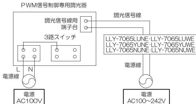
※照明器具をAC200V以上で使用する場合は、必ず調光器と照明器具の電源を別途設けてください。
