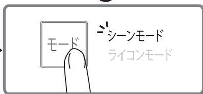
「モード」ボタンをタッチすると、現在のモード表示が点滅します。「モード」ボタンを押すたびにシーンモードとライコンモードが切り替わります。
