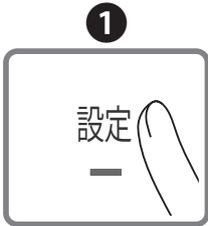
「設定」ボタンを押します。設定ボタン下側がオレンジ色に点灯します。
