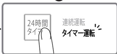
「24時間タイマー」ボタンをタッチすると、現在の運転モード表示が点滅します。「24時間タイマー」ボタンを押すたびに「連続運転」と「タイマー運転」が切り替わります。
