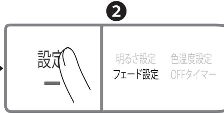
「設定」ボタンを押してフェード設定に切り替えます。選択中は表示がオレンジ色に点灯します。
