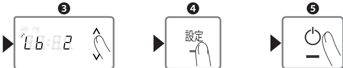
デジタル表示部横の矢印ボタンで設定を変更します。③に戻るときは「ON/OFF」ボタンをタッチします。
