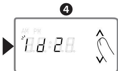
デジタル表示部横の矢印ボタンで設定を変更します。②に戻るときは「ON/OFF」ボタンをタッチします。
