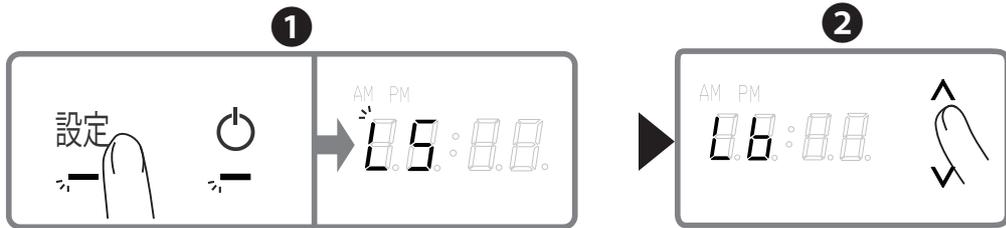
「設定」ボタンを長押しします。設定ボタンとON/OFFボタンの下側がそれぞれオレンジ色と赤色に点滅し、デジタル表示部に「LS」が点滅表示します。
