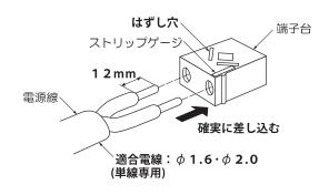
電源線を取外す場合は、マイナスドライバー等をはず し穴に差し込み、電源線を引き抜く。
