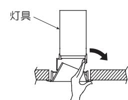
※ ハニカムルーバー(別売)取付時の首振調整は、ハニカムルーバーが変形する場合がある為、枠から本体を取り出し角度調整をして下さい。
