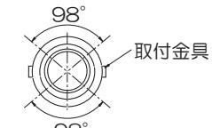
※ 照射方向に首振りが30°動かない時は7、8、9を参考に枠を取り外して、照射方向シールを合わせて、取付けてください。
