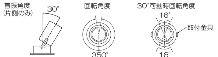
※照射方向に首振り角が30°動かない時は7、8、9を参考に枠を取外して、照射方向シールを合わせて、取付けてください。
