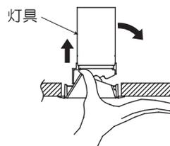
※ハニカムルーバー(別売)取付時の首振り調整は、ハニカムルーバーが変形する可能性がある為、枠から本体を取り出し角度調整をして下さい。
