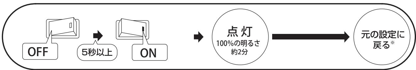
注) 上記壁スイッチ操作を行うと、周囲の明るさに関係なく壁スイッチを「ON」にした直後は約2分間LEDが点灯し、元の設定に戻ります。
