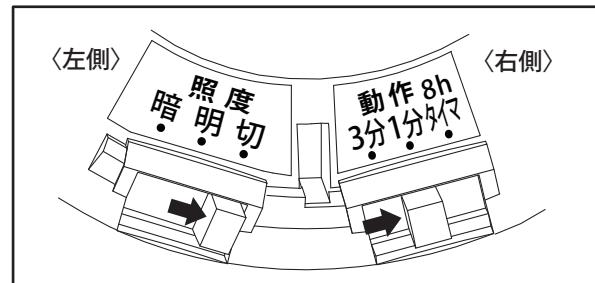
※出荷時の各スイッチ位置は、点灯照度設定スイッチ「切」、動作設定スイッチ「ON/OFF1分」となっています。
