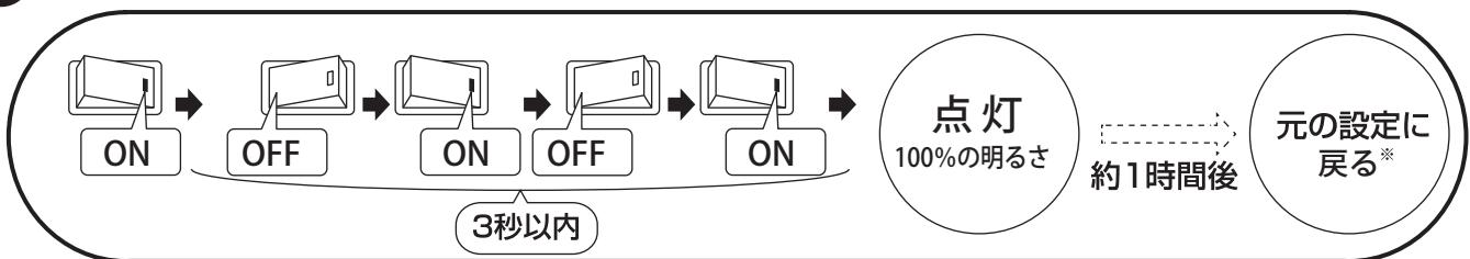
注) 上記壁スイッチ操作を行うと、約1時間連続点灯します。
