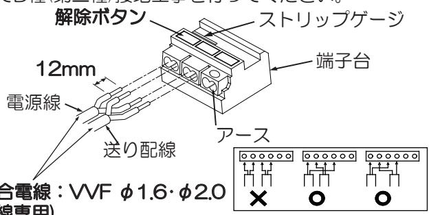
適合電線: VVF  $\phi 1.6 \cdot \phi 2.0$
