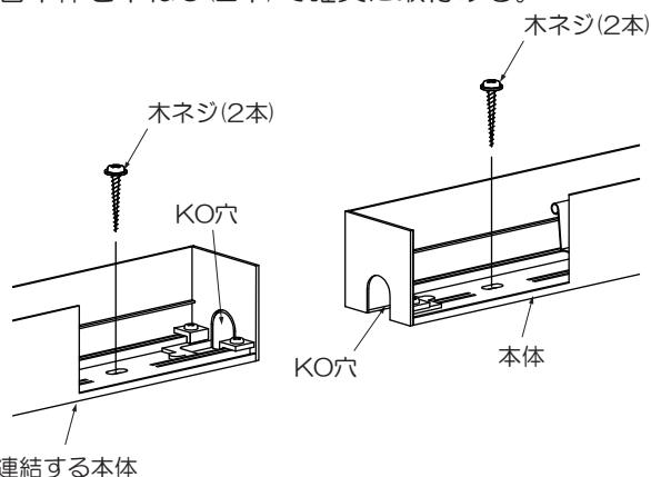
※壁面取付けの場合、取付方向は横長付け専用です。
