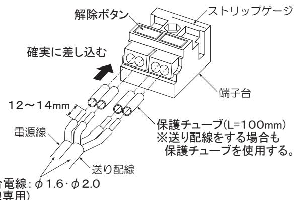
電源線を取り外す場合は、マイナスドライバー等で解除ボタンを押しながら、電源線を引き抜く。
