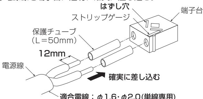
電源線を取り外す場合は、マイナスドライバー等をはずし穴に差し込み、電源線を引き抜く。
