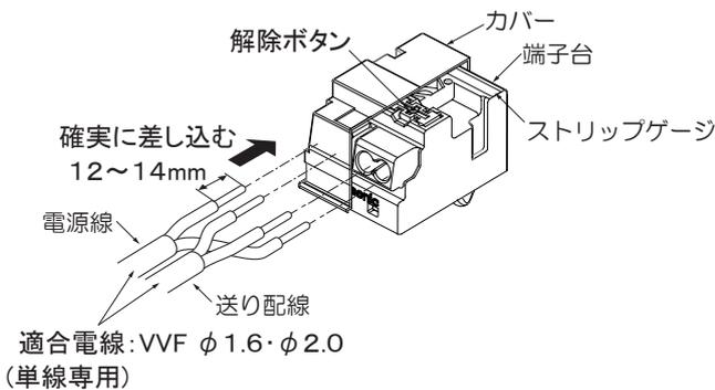
電源線を取外す場合は、マイナドライバー等で解除ボタンを押しながら、電源線を引き抜く。
