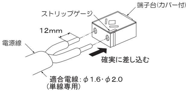
電源線を取外す場合は、カバーを取外してマイナスドライバー等はずし穴に差し込み、電源線を引き抜く。
