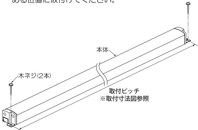
※壁面取付けの場合、横長付け・縦長付けのどちらでも取付可能です。
