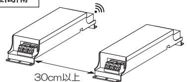
\*SENMU専用製品を含む、他の2.4GHz帯無線通信機能を持つ製品と使用する場合も30cm離してください。
