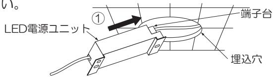
②取付バネ(3本)を両手でせばめながら、埋込穴に本体をコネクタ側から挿入してください。
