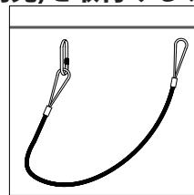
①スクリュージョイントを本体の落下防止ワイヤー取付穴に取付ける。
