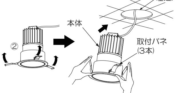
③埋込穴に本体を挿入して枠を押し上げてください。
