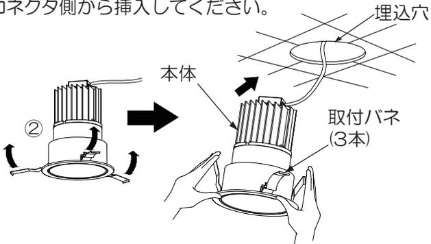
③埋込穴に本体を挿入して枠を押し上げてください。
