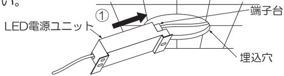
②取付バネ(3本)を両手でせばめながら、埋込穴に本体をコネクタ側から挿入してください。
