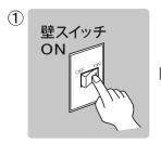
チャンネル設定を行う 器具(1台)のみを壁ス イッチONにする 「周囲のリモコン照明器具は、 、必ず壁スイッチOFFにする\*1)
