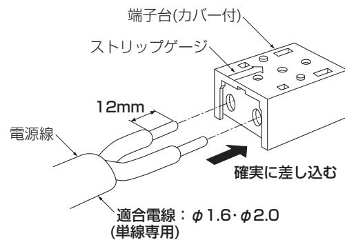
電源線を取り外す場合は、カバーを取り外してマイナスドライバー等をはずし穴に差し込み、電源線を引き抜く。
