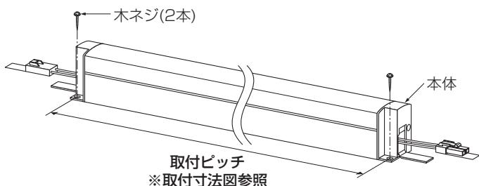
※壁面取付けの場合、横長付け・縦長付けのどちらでも取付可能です。
