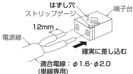
電源線を取外す場合は、マイナスドライバー等のはずし穴に差し込み、電源線を引き抜く。
