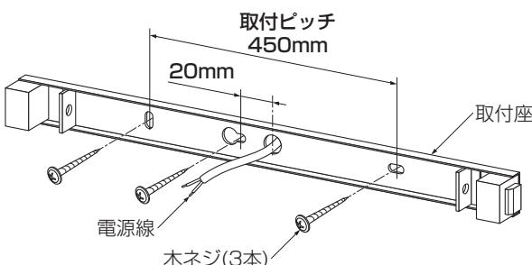
※壁面取付けの場合、横長付け・縦長付けのどちらでも取付可能です。
