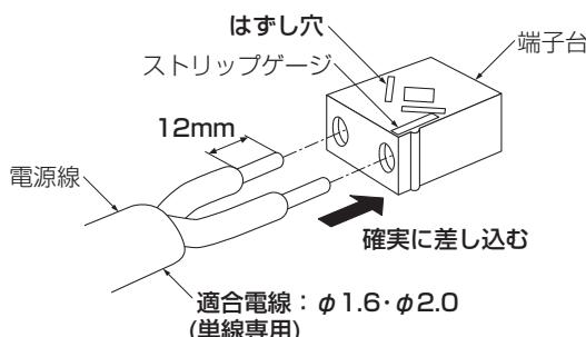
電源線を取り外す場合は、マイナスドライバー等をはずし穴に差し込み、電源線を引き抜く。
