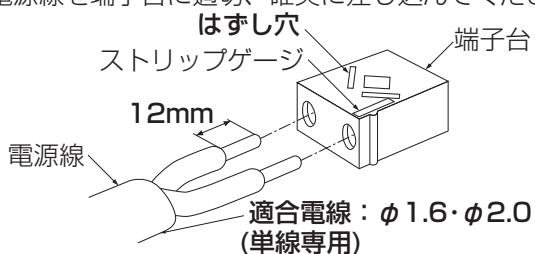
電源線を取り外す場合は、マイナスドライバー等をはずし穴に差し込み、電源線を引き抜く。
