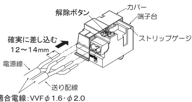
電源線を取り外す場合は、マイナスドライバー等で解除ボタンを押しながら、電源線を引き抜く。
