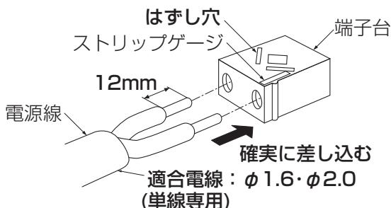
電源線を取り外す場合は、マイナスドライバー等をはずし穴に差し込み、電源線を引き抜く。
