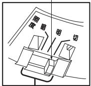
点灯照度設定ツマミを動かすことでセンサーが動作する明るさの設定ができます。
