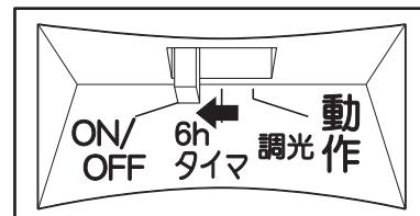
※出荷時の各ツマミ位置は、点灯照度設定ツマミ「切」、動作設定ツマミ「ON/OFF」となっています。
