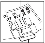
動作設定ツマミを動かすことで「調光」、「6h タイマー」、「ON/OFF」の3つのセンサー モードが設定できます。
