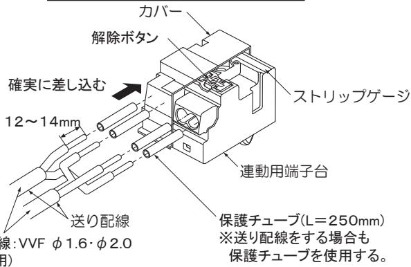
適合電線:VVF  $\phi$  1.6・ $\phi$  2.0
