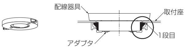
●取付座のセンター穴をアダプタに合わせ、天井に密着するまで確実に押し上げ固定する。
