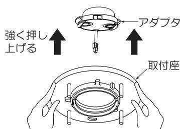
※アダプタの解除レバーの赤色が見えている場合は、取付座センター穴付近を再度押し上げてください。
