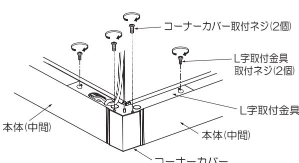
※本体(中間)とコーナーカバーを突き合わせてすき間のない状態で取付ネジを締付けてください。
