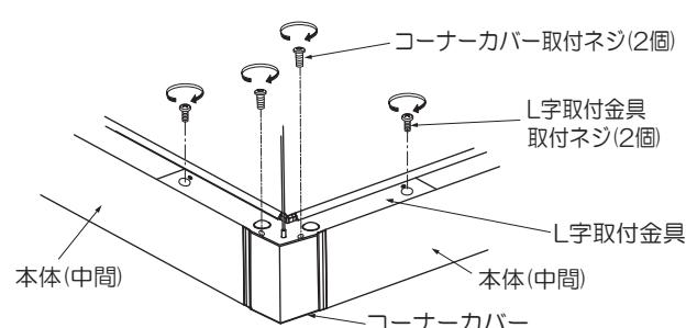
※本体(中間)とコーナーカバーを突き合わせてすき間のない状態で取付ネジを締付けてください。
