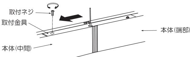
※本体(中間)と本体(端部)を突き合わせてすき間のない状態で取付ネジを締付けてください。
