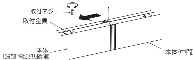
※本体(中間)と本体(端部)を突き合わせてすき間のない状態で取付ネジを締付けてください。
