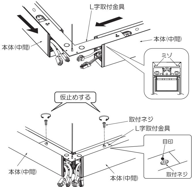
※L字取付金具のネジ穴の横の目印に取付ネジの中心がくるように仮止めしてください。
