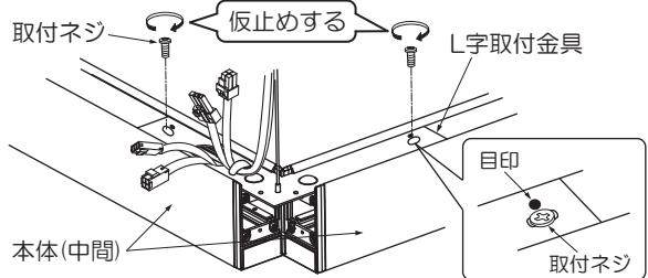
※L字取付金具のネジ穴の横の目印に取付ネジの中心がくるように仮止めしてください。
