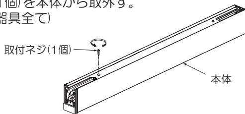
●本体のミゾにレースウェイ取付金具(2個)(別売)をスライドさせ、先に取外した取付ネジを戻し確実に締付ける。(連結する器具全て)
