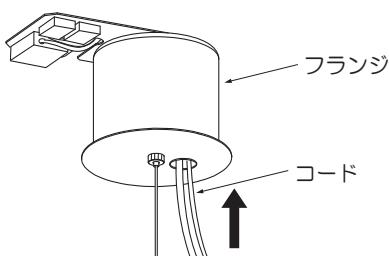
※必ずワイヤーの長さは左右同じ長さにして、本体が水平になるように調整してください。
