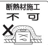
住宅の断熱施工天井ではご使用できません。住宅以外の断熱施工天井でご使用の場合の施工方法
