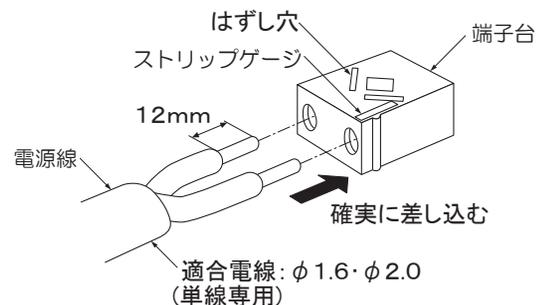
電源線を取外す場合は、マイナスドライバー等をはずし穴に差し込み、電源線を引き抜く。
