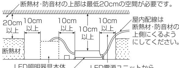
屋内配線は断熱材・防音材の上側にくるようにしてください。
