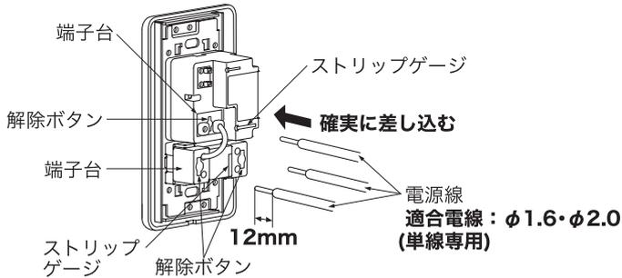
●信号線を端子台に適切、確実に差し込む。
