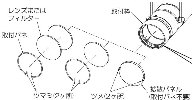
レンズまたはフィルターをはめ込んで取付バネのツマミを矢印方向につまみ、取付枠の取付ミゾにバネを取付けてください。
